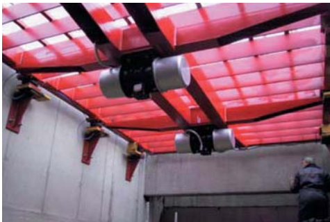
Sieben von grobem Schüttgut mit Elektro-Außenvibratoren
