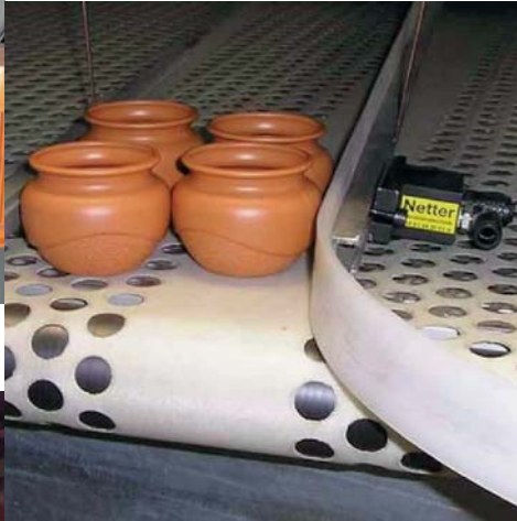
Vermeiden von Produktstaus mit Druckluft-Kreisschwingern
