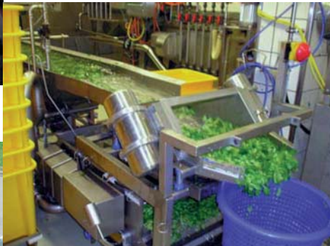
Fördersiebrinne, angetrieben mit Edelstahl-Elektro-Außenvibratoren
